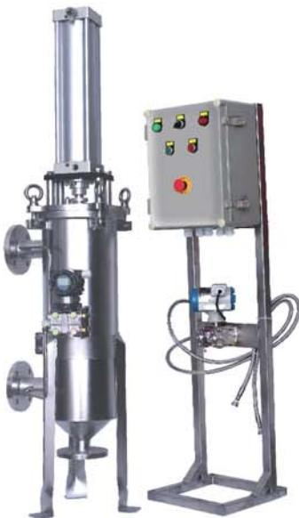
气动刮刀式自清洗过滤器，通过高效的机械刮除方式来自动清除滤元表面的颗粒杂质。能够单机连续性在线过滤，不产生过滤耗材，无需人工频繁清洗，适用于一般及高粘性液体过滤。
