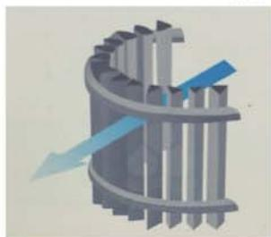
V-SLOT滤元，为长缝型过滤开孔设计，缝隙为梯形开口，不易被杂质卡死，长期保持稳定的流量。内表面缝宽即为过滤精度，缝隙均匀一致，高开孔率，精度范围50-1500微米。刮刀沿缝隙方向刮除，适合常规过滤要求。内表面光滑平整，圆度精准，刮除效果好。一体精密成形，结构坚固，经久耐用。316L材质滤网，抗腐蚀性能出色，可过滤较棘手杂质，如泥油杂质、软性结块杂质等。
