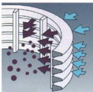
MDS-CF过滤器配备V-SLOT缝隙型精密金属滤元，滤元有两种可选，A型过滤面积0.267平方米；B型过滤面积0.314平方米，B型过滤面积比A型多17%，适用小于100微米以下的过滤，过滤器可以更紧凑，A型适用大于100微米以上的过滤。V-SLOT滤元具有以下突出优点：
