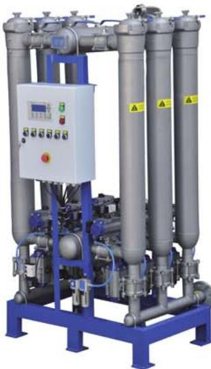
模块化自清洗过滤器基于模块化理念设计，将多个标准过滤单元组成全自动过滤系统。该系统安全系数高，可按流量需要灵活增加在线单元数量。模块化自清洗过滤器自动化运行，免人工清洗，扩展性强，可外接高压反冲洗流体，低压差工作，采用V-SLOT滤元，反冲洗彻底，反冲洗耗用液体少。模块化自清洗过滤器能净化流体，保护后道关键设备，也能利用其反冲洗排出液回收昂贵固体颗粒。产品适用于低粘性液体，如：原水、污水、汽油、重型焦化汽油、柴油、渣油等。
