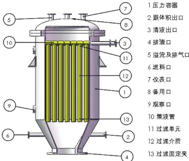
为解决敞开式过滤器造成的环境污染，同时提升滤饼的干燥度，我们研发出完全密闭的烛式过滤器。
